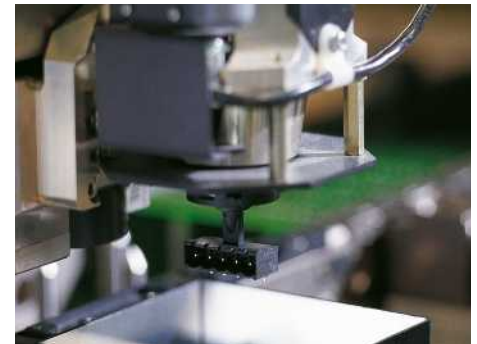
Компонент на монтажной головке
