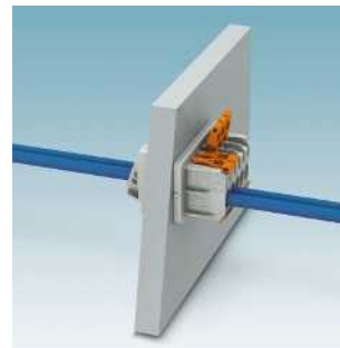
Серия PLW 16: пружинные зажимы Push-Lock, до 76 А, снаружи рычажок, внутри пружина Push-in PLW 16... Стр. 605
