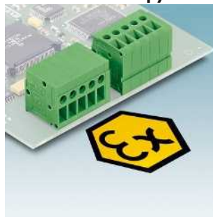
Горизонтальные и вертикальные клеммы для печатных плат, с подключением проводников спереди, шаг выводов 5,0 мм, сечение проводов 2,5 мм 2 FRONT 2,5/...-EX Стр. 158
