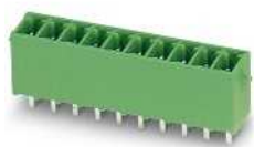
С соединительными выступами, подключение перпендикулярно печатной плате
