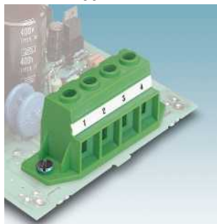
Серия MKDSP 25: винтовые зажимы, до 125 А, шаг 15 мм MKDSP 25... Стр. 455
